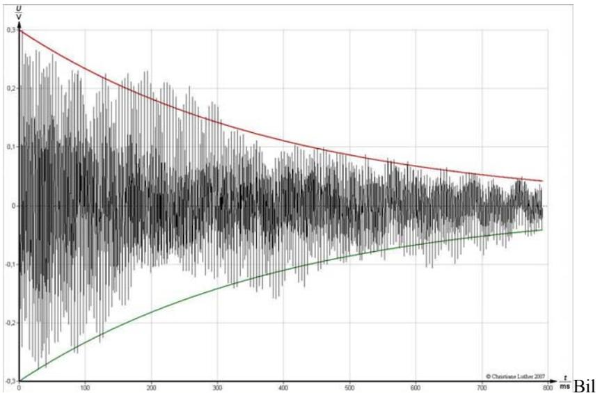
Bild 1: Reale Messung des Kammertons a mit angenäherter Amplitudenfunktion
