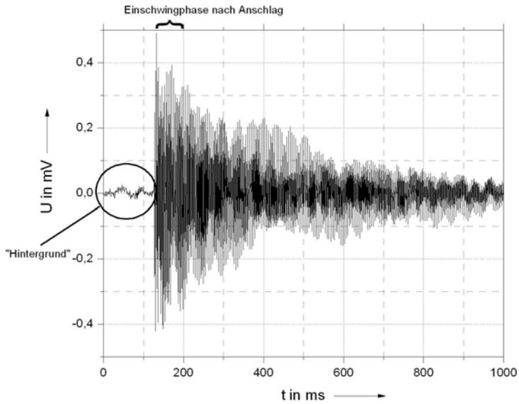
Bild 4: Originalmessung der Saitenschwingung
