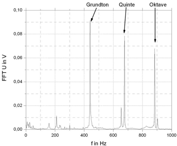
Bild 5: Grund- und Obertöne der Messung (fast Fourier transform)
