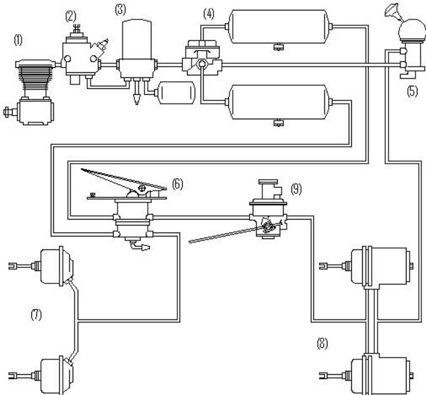
Schematische Darstellung einer Druckluftbremsanlage [2]
