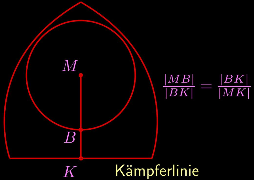
Fensterformen mit guter Gesamtwirkung:  $b = h$  (die Höhen der beiden Spitzbögen mit gleicher Basisbreite stehen dann etwa im goldenen Schnittverhältnis (weniger als  $1/4$  Fehlerprozent)).
