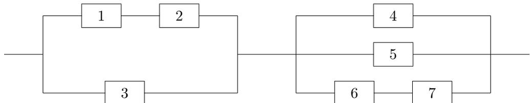
Das Ereignis  $A_i$  bedeute, dass das  $i$ -te Bauelement ( $i = 1, 2, \dots, 7$ ) während der Zeit  $t$  nicht ausfällt, und  $S$ , dass das System nicht ausfällt. Drücken Sie die Ereignisse  $S$  und  $\bar{S}$  durch die Ereignisse  $A_i$  aus!
